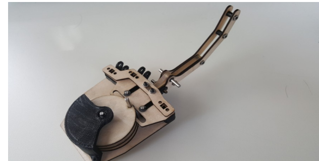
Un exemple de prototype réalisé en découpe laser bois, car c'est facile et peu cher
