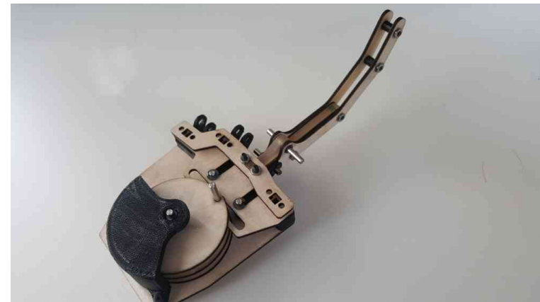
Un exemple de prototype réalisé en découpe laser bois, car c'est facile et peu cher
